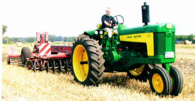
Kann das gut gehen: ein 50-PS-Schlepper mit Benzinmotor vor einer 3-m-Scheibenegge? – Motormäßig kein Problem, wohl aber gewichtsmäßig. Fotos: Wiege
