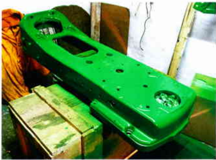
In Marcus Wieges Garage wurde der Schlepper bis zur letzten Schraube zerlegt, gereinigt und neu lackiert, hier der Rahmen des Vorderteils.
