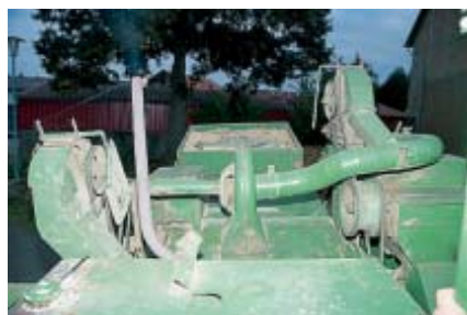
Blick vom Fahrerstand nach hinten. Rechts die Nachreinigung, in der Mitte das Gebläse dafür. Der Ausputz wird in einen extra Sack geblasen.
