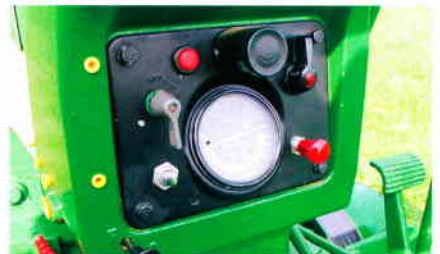
So sieht der Traktormeter nach der fachgerechten Überholung aus. Man beachte die Armaturenbeleuchtung oberhalb der Anzeige!
