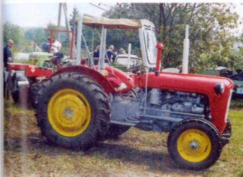
Der IMT 533 (28 PS) aus Jugoslawien ist ein Lizenzbau des MF FE 35. Diese Schlepper wurden ab 1961 in die DDR importiert.
