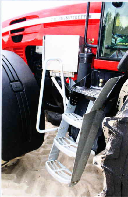
Neben dem Höherlegen der Elektrik wurde die Batterie wasserdicht in einem Edelstahlgehäuse untergebracht. Aufstieg und Tankunterfahrerschutz wurden verzinkt.
