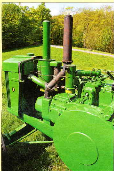
John Deere baute wie Lanz liegende Motoren in seine Traktoren ein. Ob das Konzept bei der Übernahme eine Rolle gespielt hat?
