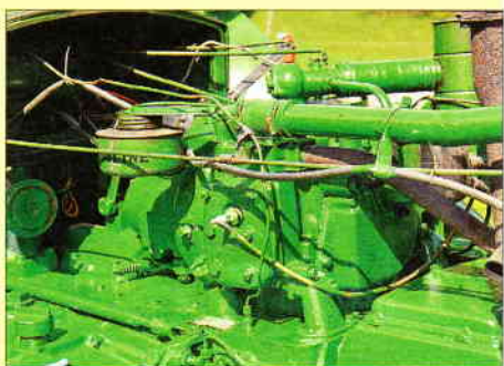
Knapp einen Liter Benzin fasst der kleine Schraubtank des Zweizylinder-Boxers. Das reicht für vier-, maximal fünfmal starten
