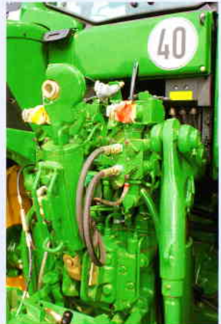
110 l/min liefert die LS-Hydraulikpumpe an die Steckkupplungen. Die Oberlenkerhalterung lässt sich leichter handhaben.
