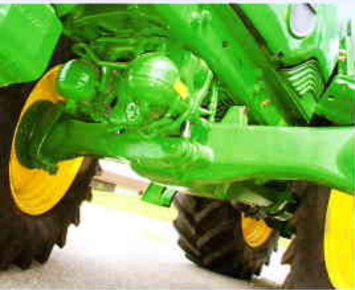
Gefederte TLS-Vorderachse. Neu ist, dass sich am Terminal eine härtere Dämpfer-rate für Frontladereinsätze einstellen lässt.
