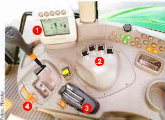
Der Farbmonitor (1) ist Standard, die E-Steuergeräte (2) gibts auf Wunsch. EHR-Pult (3) und Handgas (4) sind vertraut.
