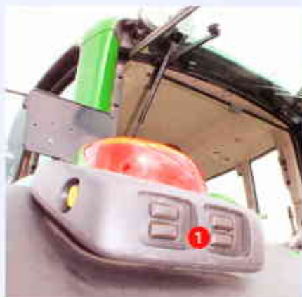
Jetzt sitzen Druckknöpfe im Träger (1), um ein Steuergerät z.B. für den hydraulischen Oberlenker bedienen zu können.
